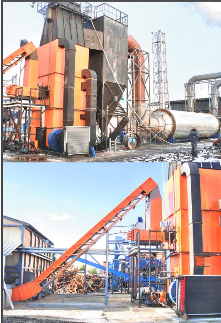
Теплогенератор УТПУ-ТГ/ТЯ 7МВт Украина, Житомирская обл.
